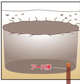
長さ1m以上、幅50cm程度の穴を掘り、穴の端にアース棒を打設する
