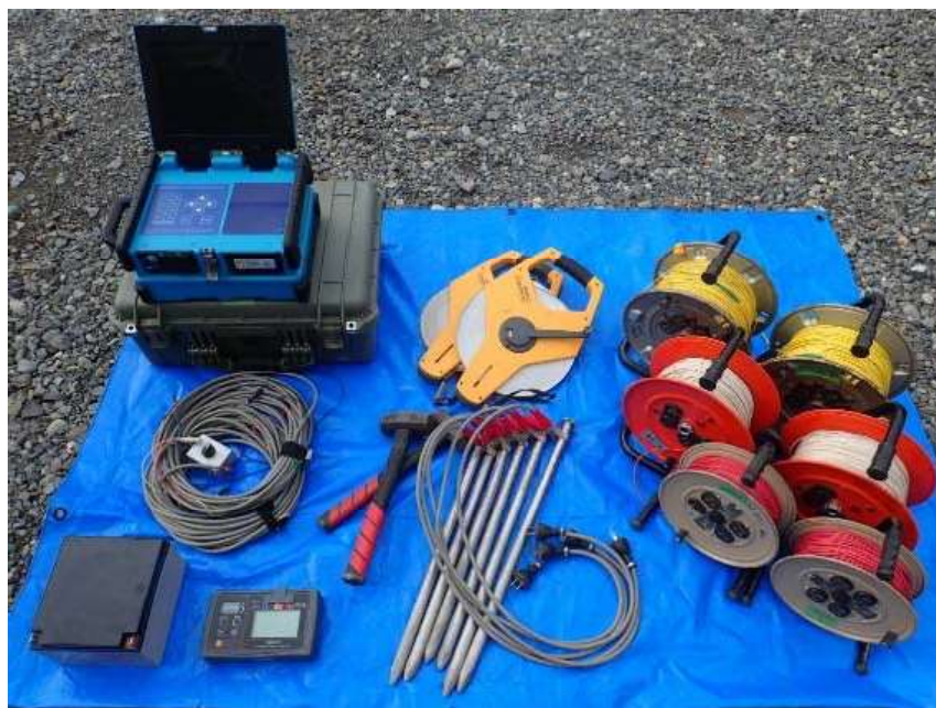
大地抵抗率測定の測定機材
