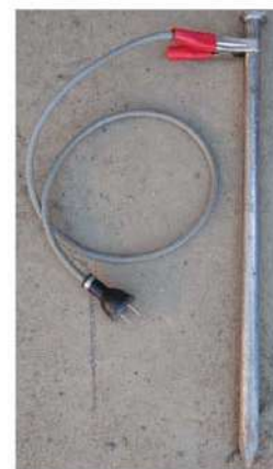
打込む電極 Φ20×500mm程度
