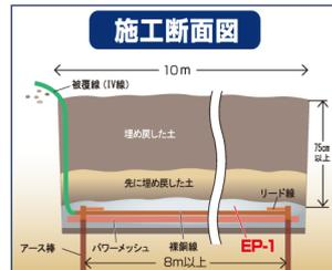
**特長：小規模な変電所など限られたスペースで多様な形状で施工できます**
