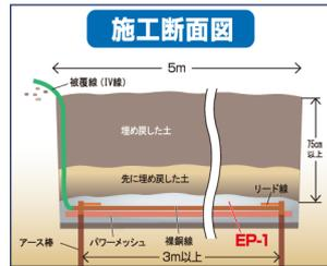
**特長：本格的な帯状接地工法ができる5mセット 必要な資材が全て含まれて使い勝手抜群です**
